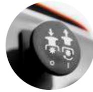
Cuchillas de acoplamiento eléctrico: basta con tirar del interruptor situado en el panel de control
