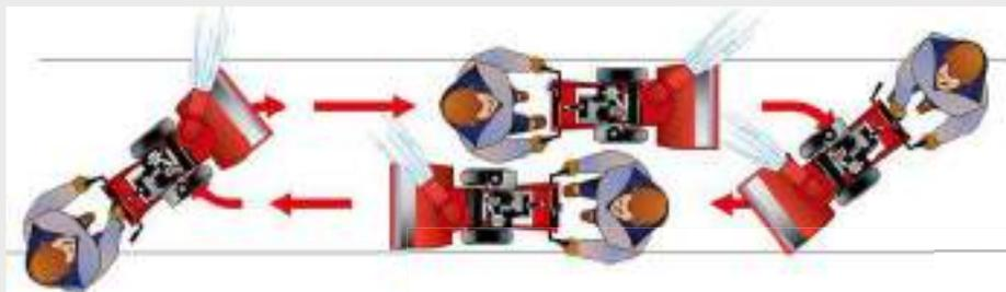
**Free Hand Control™ (Control mano libre)** es un sistema en el que el usuario puede continuar manejando el quitanieves con una sola mano por cuestiones de ajustes o regulación de la cánula con la otra mano. Utilizando este sistema y Easy Turn™ (Giro fácil), el usuario puede cambiar el sentido de trabajo del quitanieves y regular la boca de desalojo de nieve simultáneamente para una limpieza más rápida y efectiva.
